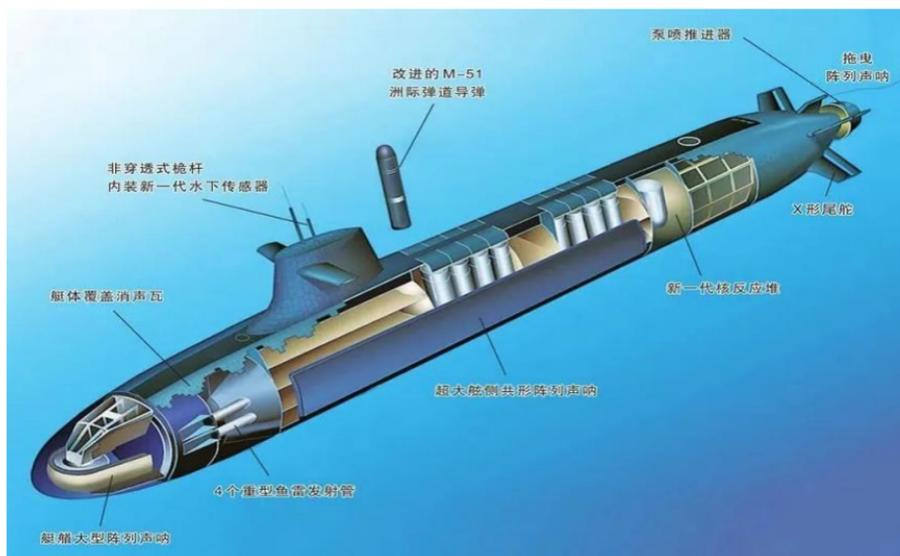
法国第三代弹道导弹核潜艇长约 150 米、满载排水量 1.5 万吨，建成后将是法国最大的战略核潜艇。增大的艇体既有利于安装新一代核反应堆系统，又能满足改进型 M-51 洲际弹道导弹的搭载需求，同时也为艇艏配备大型阵列声呐提供了充裕空间。
