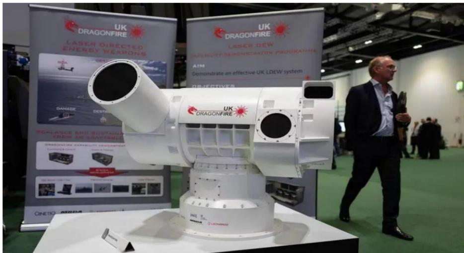
目前，英国国防部拒绝透露“龙火”项目更多的详细技术指标，特别是射程，只表示该武器“是一种视距内武器，可以与任何可见目标交战；激光扩散的精度水平相当于从‘一千米外击中一枚1英镑的硬币’”。俄媒体直接报道为“以击毁一千米距离内硬币大小的可见目标”。根据英方早前公开的信息，“龙火”系统的最大功率在50kw左右，并保留了进一步提升的余地。
